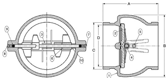
**NOTA:** Las válvulas de retención de doble disco pueden ser instaladas en horizontal, y en vertical con sentido de flujo hacia arriba.
